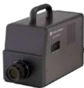
Obrázek 19: Spektro-radiometr CS-2000 (převzato z [56])
